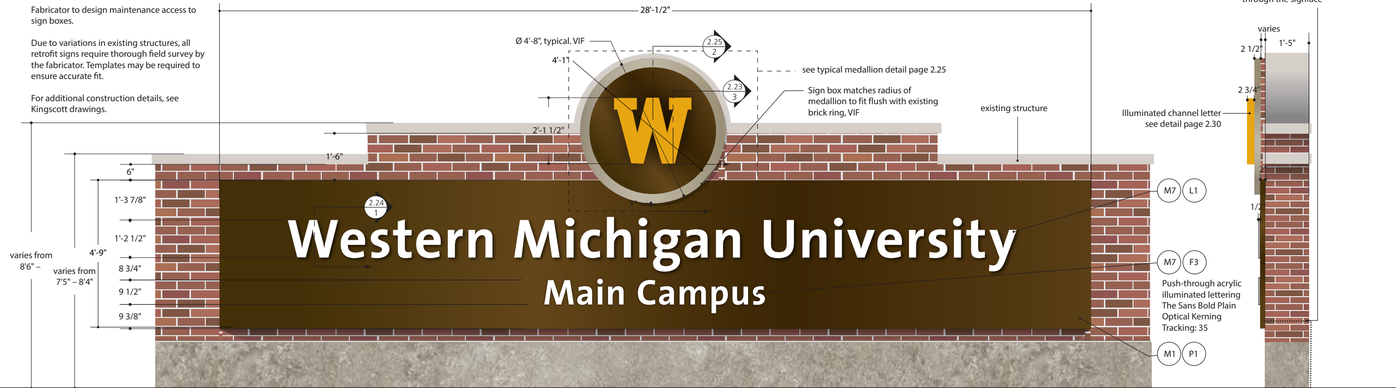
1 Elevation - Retrofit - GW04 scale: 3/8" = 1'-0"
